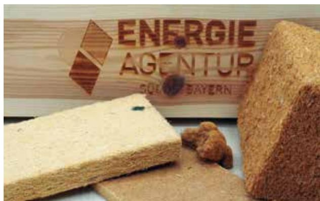
Zellulose ist eine der kostengünstigsten Möglichkeiten der nachträglichen ökologischen Gebäudedämmung, zum Beispiel bei Dachkonstruktionen. Zu Flocken geschreddert kann Zellulose auch in Hohlräume eingeblasen werden. Holzweichfaser-Dämmstoffe liegen auf Platz zwei nachhaltiger Dämmmaterialien. Das Ausgangsmaterial sind Resthölzer aus Sägewerken, die zerkleinert werden und dank holzigenem Bindemittel keine Zusatzklebstoffe benötigen. Holzweichfaser-Platten sind je nach
